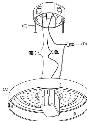
5) Appuyez la base du plafonnier DEL (A) sous la boîte de jonction en s'assurant que les vis de montage (C) passent à travers les trous de la base prévus à cet effet.
