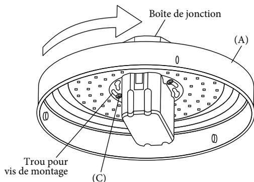
6) Tournez la base du plafonnier DEL (A) en sorte que les vis de montage (C) glissent dans les parties plus étroites des trous. Serrez les vis de montage (C) pour que la base soit complètement appuyée au plafond.
