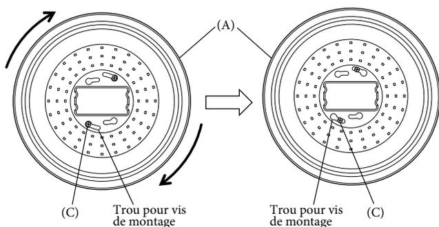
7) Installez l'abat-jour (B) sur la base du plafonnier DEL (A) puis tournez celui-ci dans le sens des aiguilles du montre jusqu'à ce que l'abat-jour soit verrouillé.
